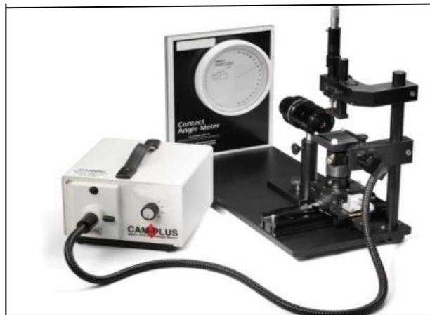
Figura. 8 Medidor de ángulo de contacto marca CAM PLUS modelo 2000
