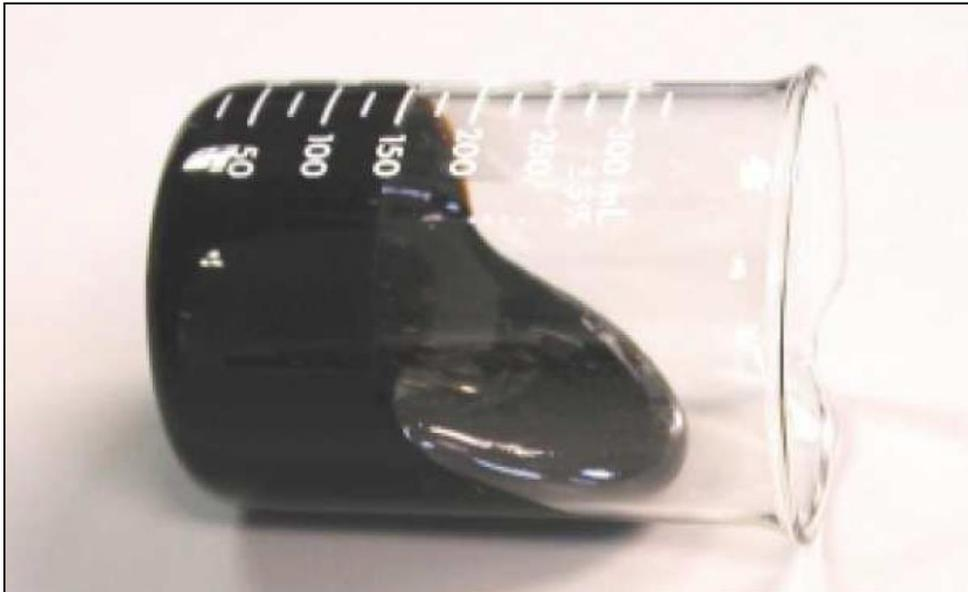
Fig A.1. Ejemplo de un Crudo Pesado
