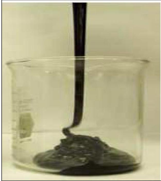
**Fig A.2. Ejemplo de un Crudo Extra Pesado**
