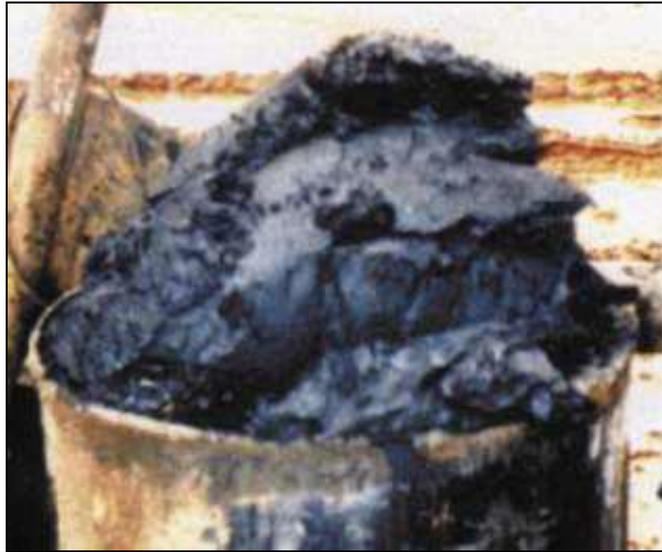
**Fig B.2. Asfáltenos Obtenidos de un Pozo Petrolero**
