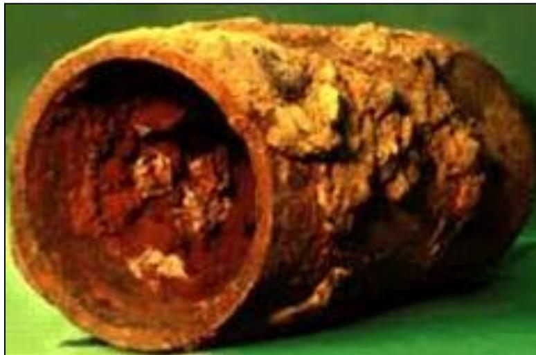
**Fig B.3. Tubo con Problemas de Corrosión**
