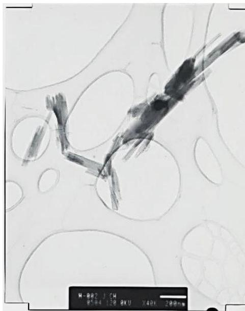
**Figura 4.9 Microscopía Electrónica de Transmisión de la haloisita H002**
