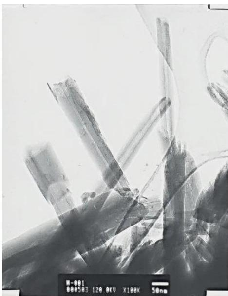
**Figura 4.8 Microscopia Electrónica de Transmisión de la haloisita H001**
