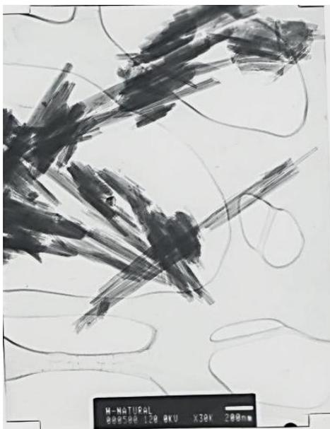
**Figura 4.7 Microscopia Electrónica de Transmisión de la haloisita natural**
