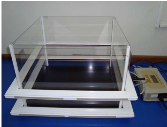
Figura 5. Prueba de actividad locomotriz. Monitor automatizado de actividad locomotriz.
