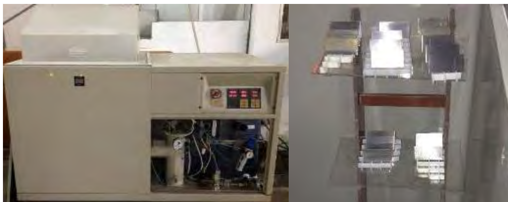
Figura 2.6 Cámara de Niebla Salina donde se llevaron a cabo la exposición al ambiente corrosivo y muestra del acomodo de las placas dentro de la Cámara de Niebla Salina
