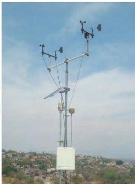
Figura 4.3: Anemómetro y veleta del IER.
