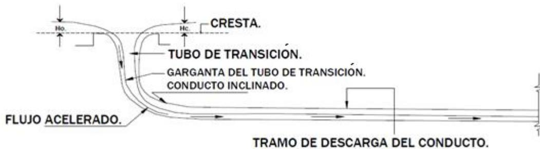
Figura. 3.2.3.2. Funcionamiento de Vertedor de Embudo.<sup>1</sup>
