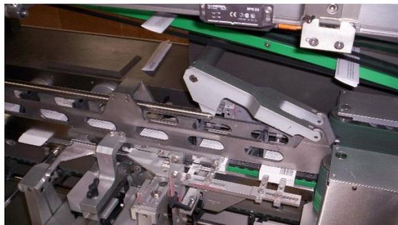
FIG. 8 <sup>(19)</sup>. Módulo de estuchado de una línea de acondicionamiento para formas sólidas
