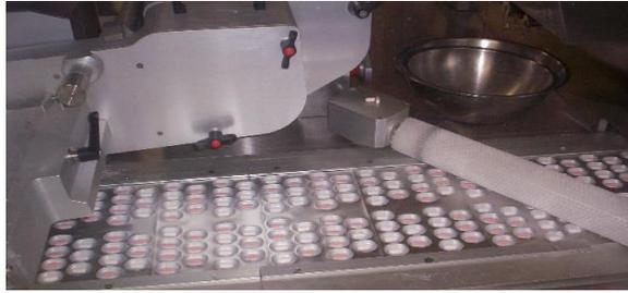
FIG. 6 <sup>(19)</sup>. Módulo de formado y llenado en una línea de acondicionamiento para formas sólidas
