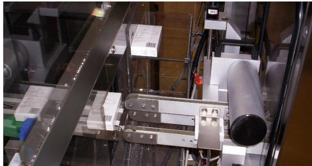
FIG. 9 <sup>(19)</sup>. Módulo de codificado de una línea de acondicionamiento de formas sólidas
