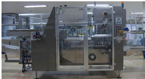
FIG. 10 <sup>(19)</sup>. Encartonadora de una línea de acondicionamiento de formas sólidas
