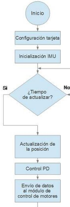
Figura 5.14 Diagrama de flujo del módulo de control y sensado.
