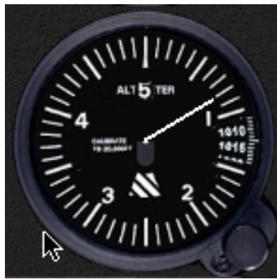
Figura 4.5 Indicador de altitud.
