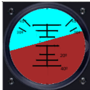
Figura 4.7 Indicador de horizonte.
