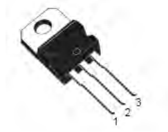
a) Encapsulado TIP41C
