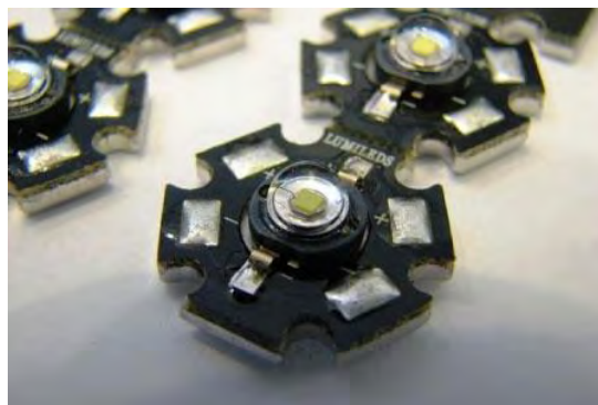
Figura 4.11 LED de potencia elegido
