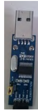
b) Adaptador RS232 a USB
