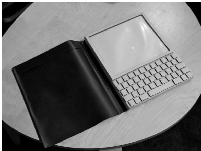
Fig. 2.2 En los años 60 Alan Kay, un informático del Centro de Investigación de Palo Alto presentó la Dynabook , una pequeña computadora a medio camino entre una laptop y la tableta actual. Funcionaba con una pantalla táctil y un teclado físico completo en la parte inferior.
