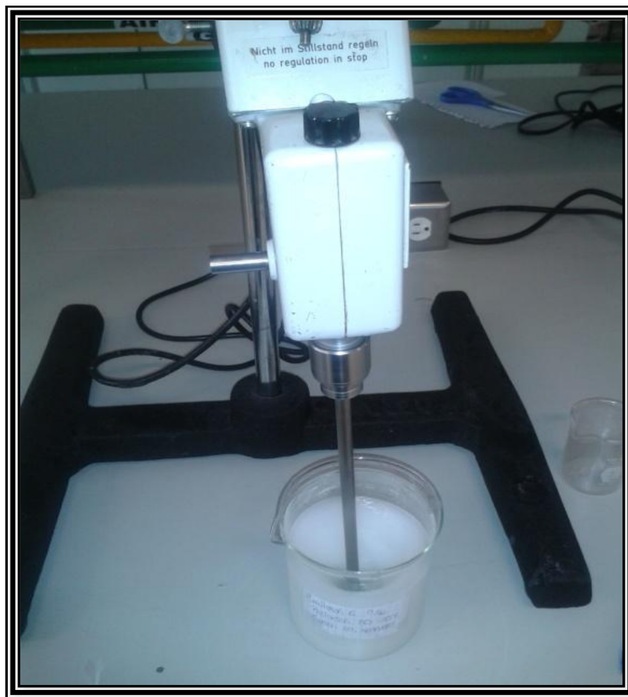
Figura 30. Homogenización con un agitador de velocidad variable.
