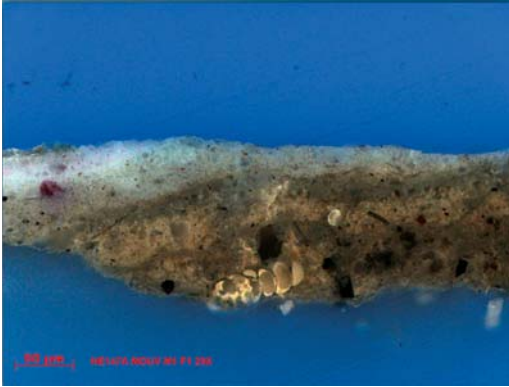
Figura 47. Corte estratigráfico procedente del cuadro San Francisco resucita a un niño en el que se aprecia una base de preparación aplicada a tres manos. Microscopía óptica con luz ultravioleta 20X. Eumelia Hernández, 2010 DR© Laboratorio de Diagnóstico de Obras de Arte, Instituto de Investigaciones Estéticas, UNAM.
