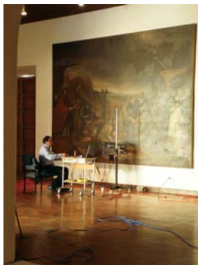
Figuras 45 y 46. Aplicación del análisis con fluorescencia de rayos X para la caracterización de pigmentos por parte del Instituto de Física de la UNAM. Eumelia Hernández, 2010 DR© Laboratorio de Diagnóstico de Obras de Arte, Instituto de Investigaciones Estéticas, UNAM.
