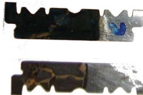
Fig 3.3. Dos películas de polímero distintas adheridas al ET. La segunda presenta desprendimiento y deterioro.
