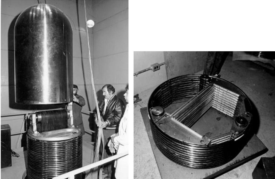
Figura I.8 Muestra el Domo metálico y sección de la columna del acelerador Van de Graaff de 5.5 MV.
