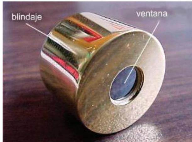
Figura I.16 Muestra un detector de barrera superficial.
