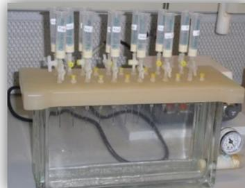
**Figura 4.20** Filtración en Cartucho Oasis
