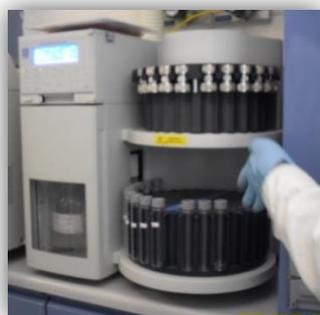
**Figura 4.27 Extracción: Equipo de Extracción Acelerada con Solventes, ASE**
