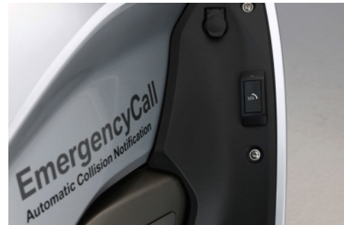
Figura 3.14 Marca en el vehículo que verifica que cuenta con el sistema eCall
