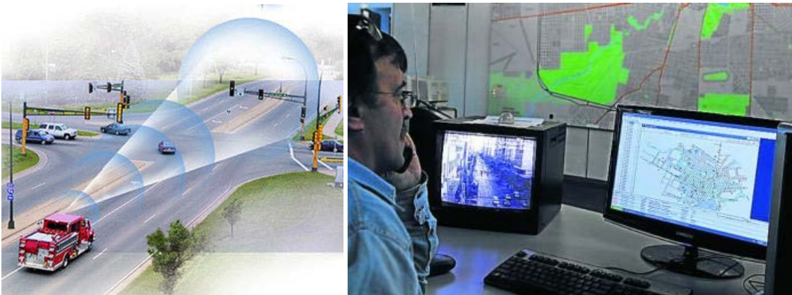
Figura 2.10 Semáforo reconoce a un vehículo de emergencia y envía una notificación al centro de control para valorar el cambio de estado.
