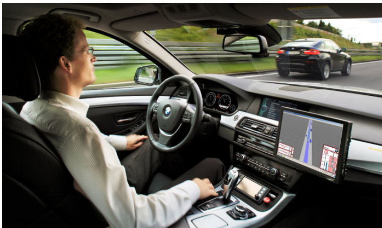
Figura 2.4 Sistema a bordo de vehículos con información de próximos cruces o advertencias
