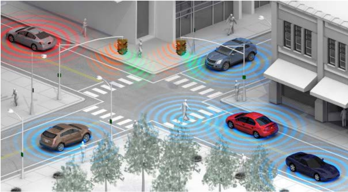
Figura 2.22 Sistema de sensores en vehículos para reconocimiento de peatones, semáforos e infraestructura
