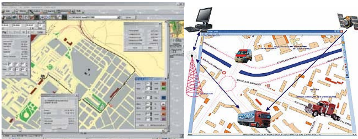
Figura 2.32 Sistema de localización automática de vehículos
