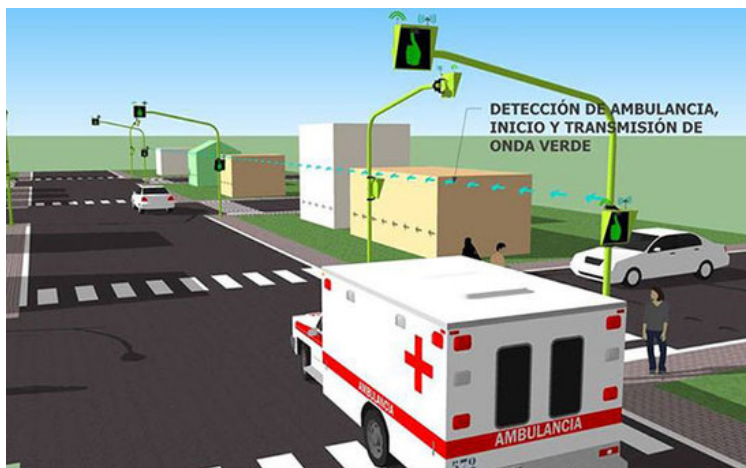
Figura 2.11 Semáforo reconoce a un vehículo de emergencia y transmite una onda de advertencia que pone los semáforos consecuentes en verde
