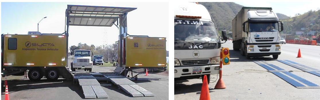
Figura 2.19 Instalaciones temporales para obtener el peso y condiciones del vehículo de carga (Venezuela).
