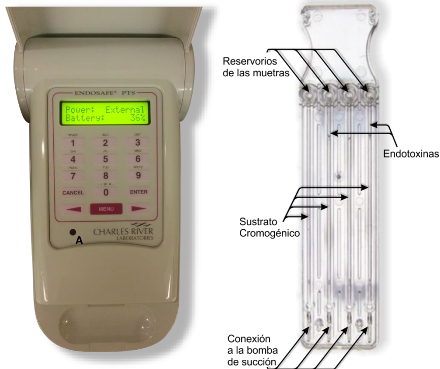
Ilustración 15. A. Equipo Endosafe® PTS, B. Cartucho utilizado en la prueba.
