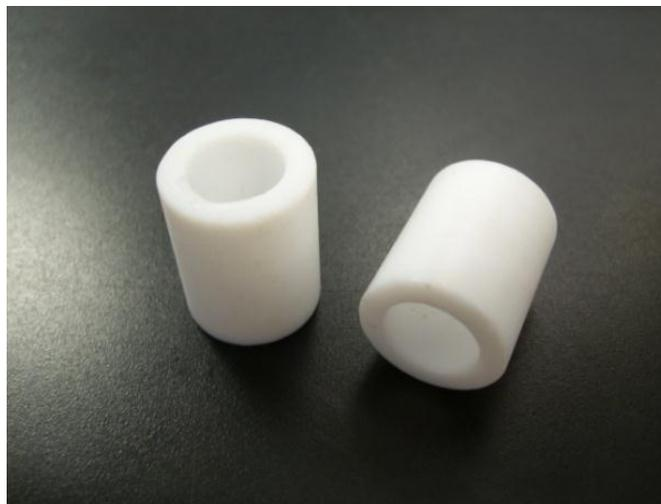
**FIGURA 19:** Moldes de teflón usados para hacer las probetas para las pruebas mecánicas de compresión
