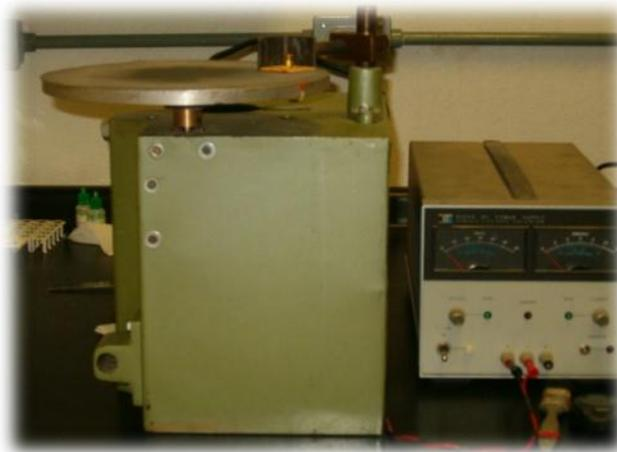
**FIGURA 17.-** Equipo de pruebas de abrasión
