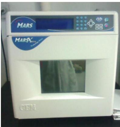
**FIGURA 15.-** Horno digestor
