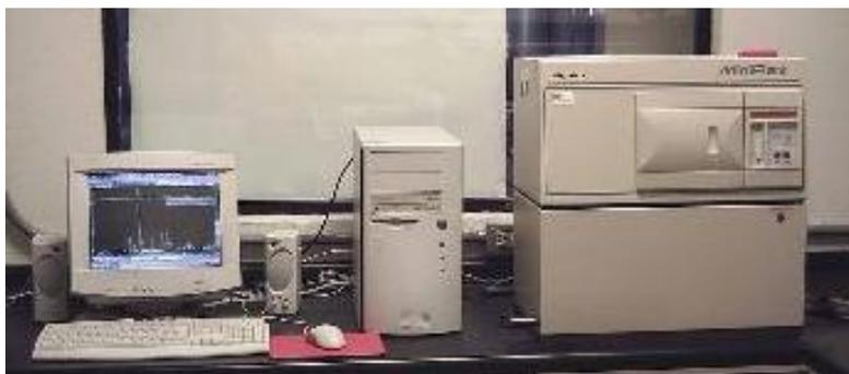
**FIGURA 12.-** Difractómetro de rayos X
