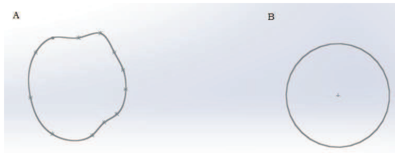
Figura A1.6 A) Perfil Transversal de una trabécula real. B) Idealización del perfil de una trabécula.
