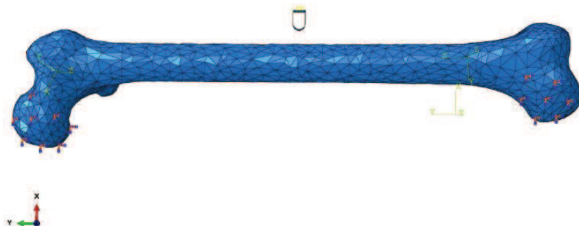
Figura 5.23 Condiciones de frontera del modelo de fémur sometido a flexión en tres puntos.
