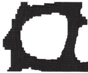
Figura 3.1 Detalle del modelo de hueso trabecular generado mediante voxeles cúbicos. Nótese el tamaño de los elementos finitos [Grenestedt, 2000].
