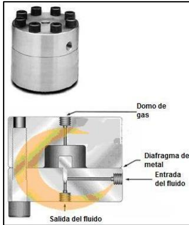
Figura 26 Diagrama del regulador de presión inversa.
