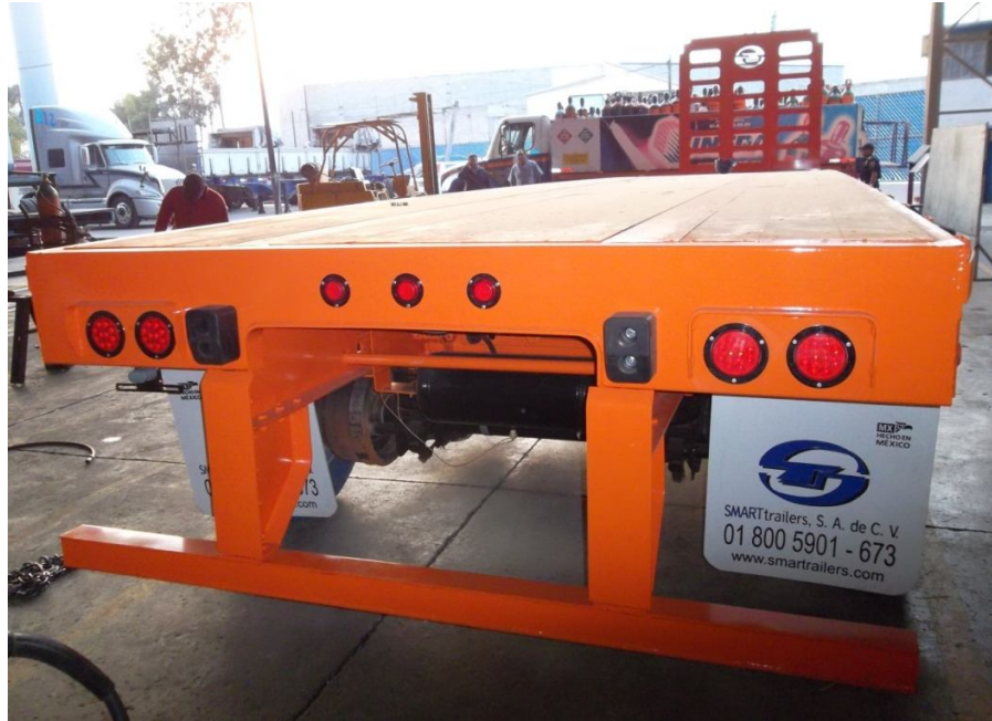
Figura 3.15. Plataforma de 48' cliente Ilhuilcamina en proceso de fabricación.
