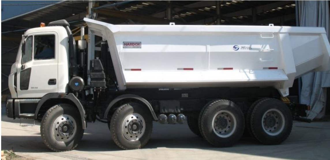
Figura 3.6. Volteo 16m 3 cola de pato, producto terminado.
