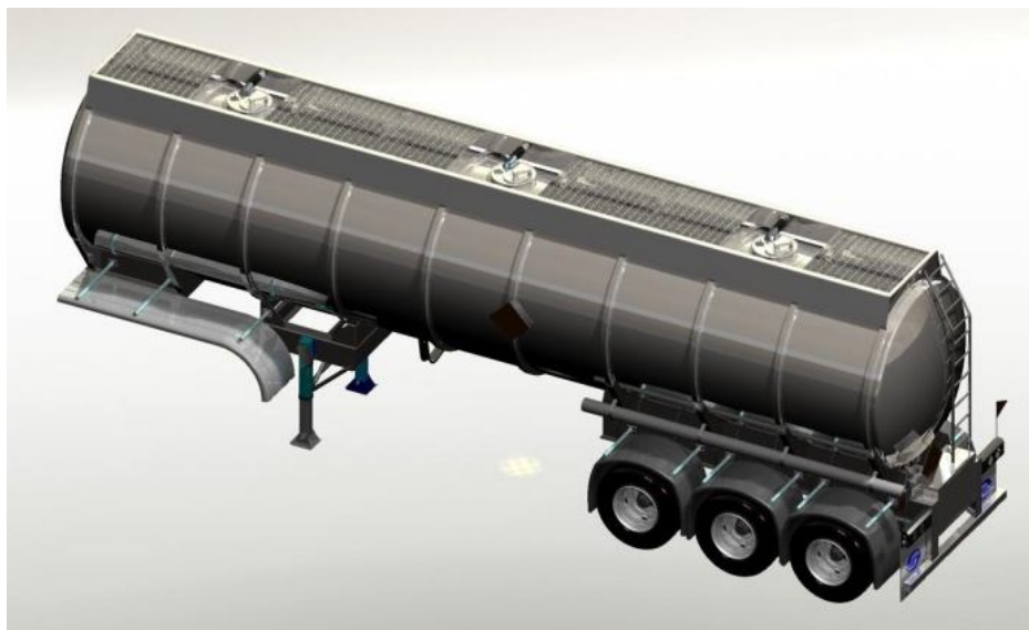
Figura 3.9. Tanque para transporte de combustible 42,000 litros de 3 compartimientos), imagen de SolidWorks.
