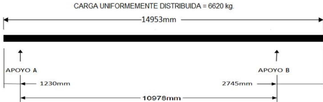
Figura 3.27. Distribución del peso de la plataforma.
