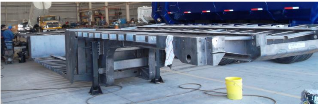
Figura 3.52. Seguimiento en fabricación de unidad prototipo (fase 2). Plataforma Kola Real.
