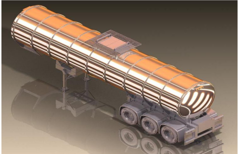
Figura 3.10. Tanque para transporte de combustible 42,000 litros de 1 compartimiento, imagen de SolidWorks.
