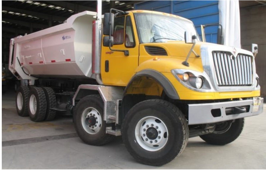
Figura 3.2. Producto final volteo de 15m 3 .
