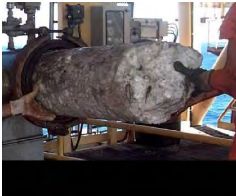
Figura 2.3 Taponamiento de una línea de flujo por formación de hidratos.
