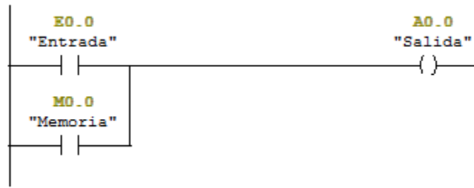
Figura 4.3 Diagrama en escalera de la programación utilizada para la prueba de comunicación
