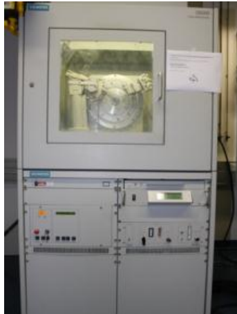
Fig. 4.2 Difractómetro Siemens D5000 utilizado para hacer el estudio de Difracción de Rayos X.
