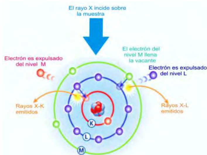
Figura 8. Modelo de excitación de un átomo por EDXRF.
