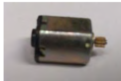
Figura 5.10. Motor CD contenido en el servomotor
