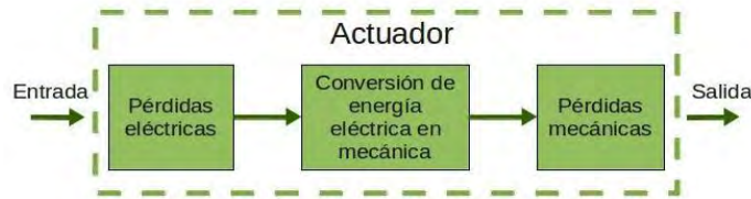
Figura 4.7. Pérdidas en un actuador eléctrico (imagen tomada y modificada de [79] )
