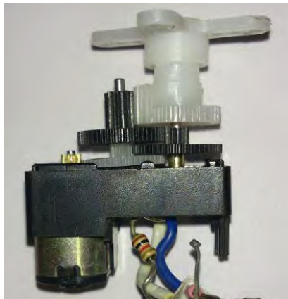
Figura 5.12. Reducción dentro del servomotor
