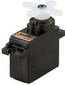
Figura 5.9. Servomotor utilizado en la CDMIT I
