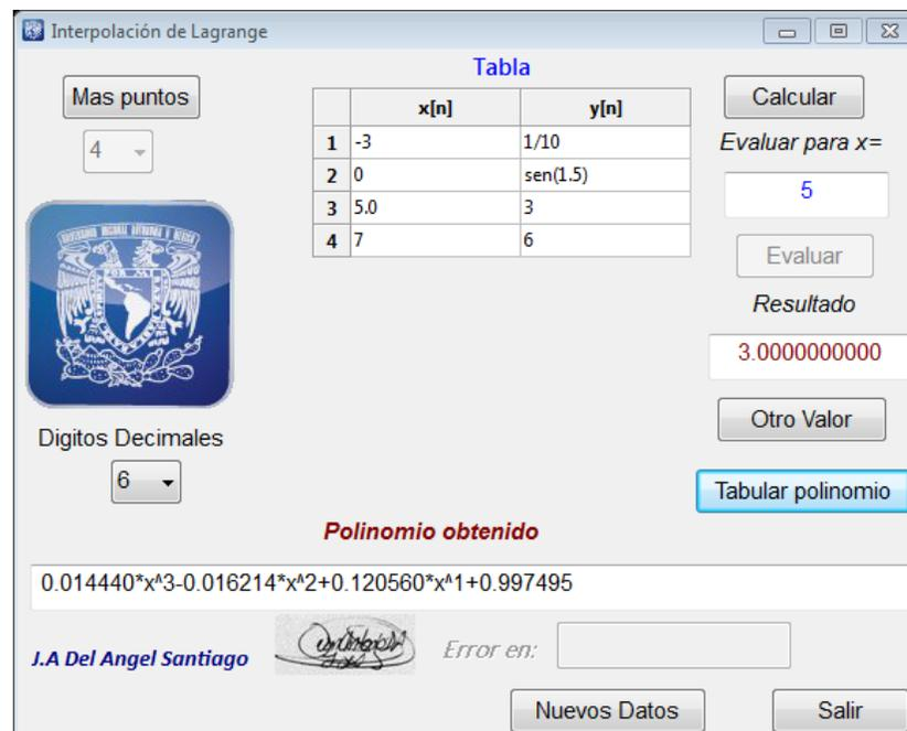
Figura 10.16 Obtención del polinomio de interpolación
