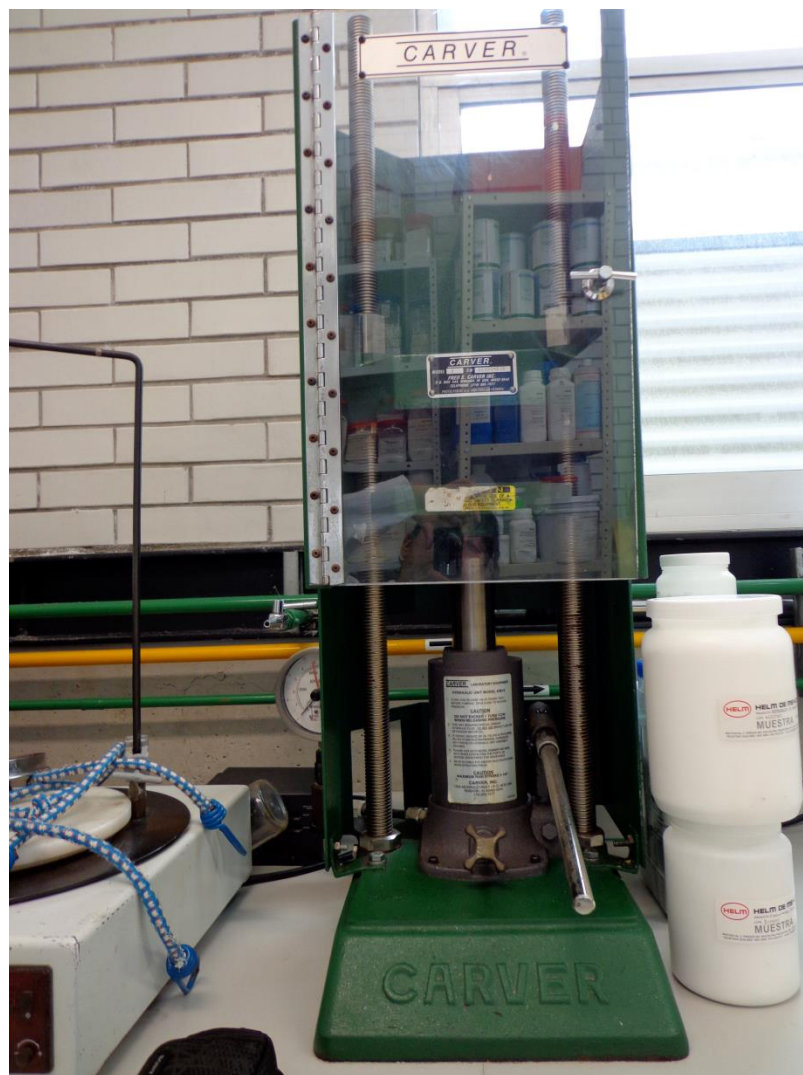
Figura 7.- Prensa hidráulica marca Carver, utilizada para comprimir (Unidad de Investigación Multidisciplinaria, Laboratorio De Ensayos de Desarrollo Farmacéutico – Facultad de Estudios Superiores Cuautitlán – UNAM).
