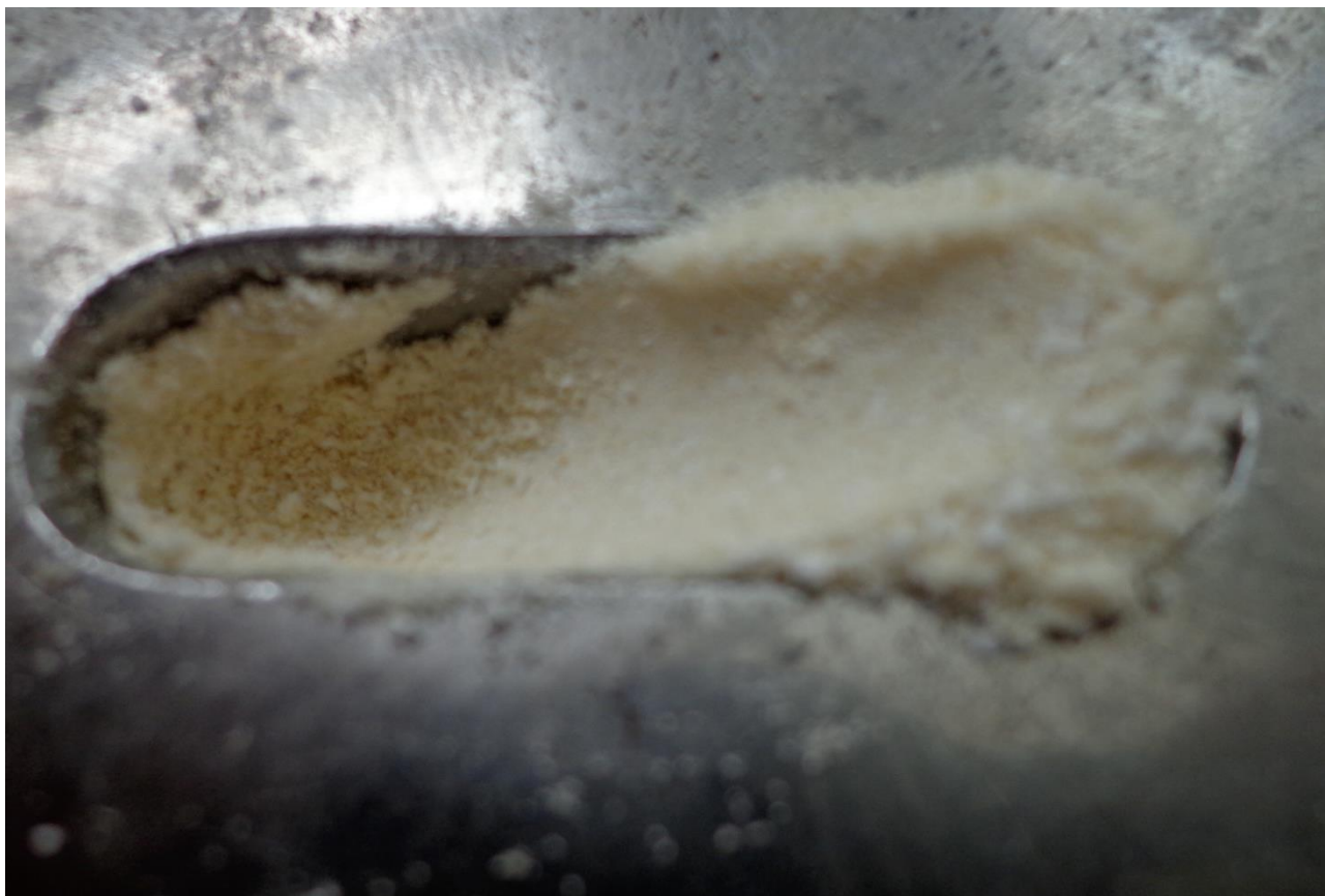
Figura 6.- Llenado de matriz de la prensa hidráulica marca Carver (Unidad de Investigación Multidisciplinaria, Laboratorio De Ensayos de Desarrollo Farmacéutico – Facultad de Estudios Superiores Cuautitlán – UNAM).
