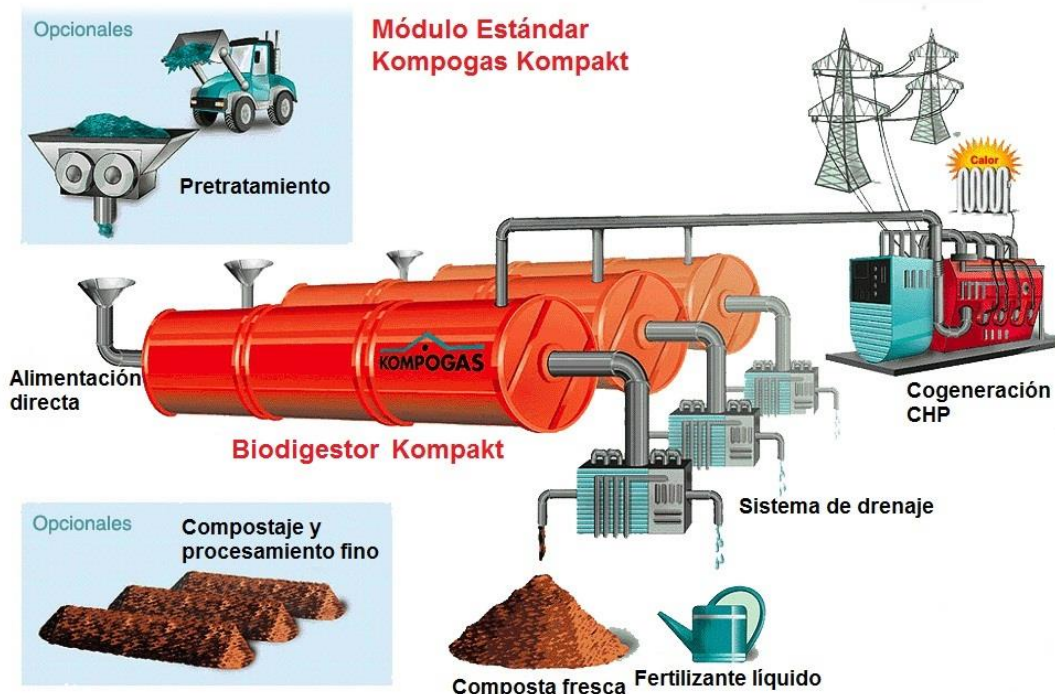
Figura 16. Esquema del proceso Kompostogas con biodigestor de acero (Axpo Kompostogas Ltd., 2012).
