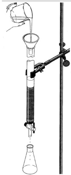
Figura 20. Esquema de una columna de purificación.<sup>23</sup>
