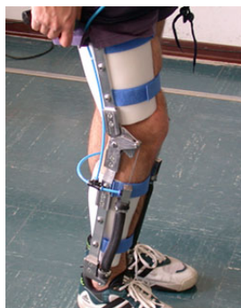
Fig 1.3: Músculos neumáticos en órtesis de pierna
