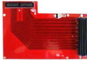
**Figura 2.11** Adaptador FMC empleado para conectar el módulo de acondicionamiento analógico conversión A/D al módulo de almacenamiento y transmisión.
