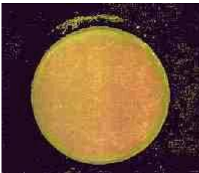
Figura 1.10. Fotoluminiscencia de una muestra de silicio nanoporoso.
