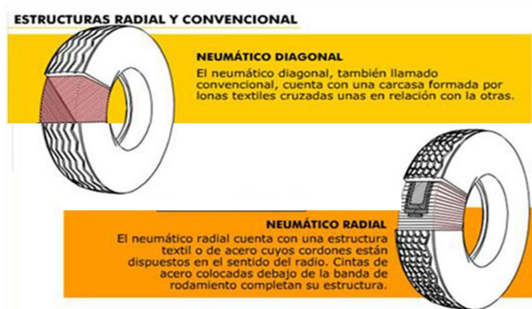
ESTRUCTURA RADIAL Y CONVENCIONAL 11
