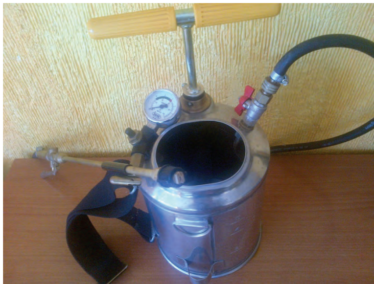
Figura 55. Bomba de compresión manual para aspersión (Fotografía de la autora y equipo Guarany facilitado por Eco Suministros S.A. de C.V.).
