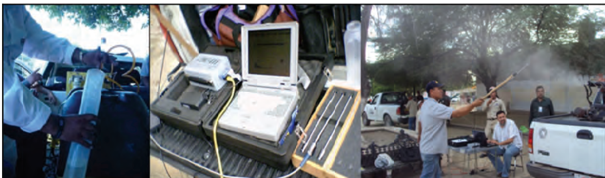
Figura 69. Calibración del equipo generador de nebulización en frío ULV para una campaña de salud Pública: Gasto por minuto de boquilla y con equipo DCIV el tamaño de la gota (237) .
