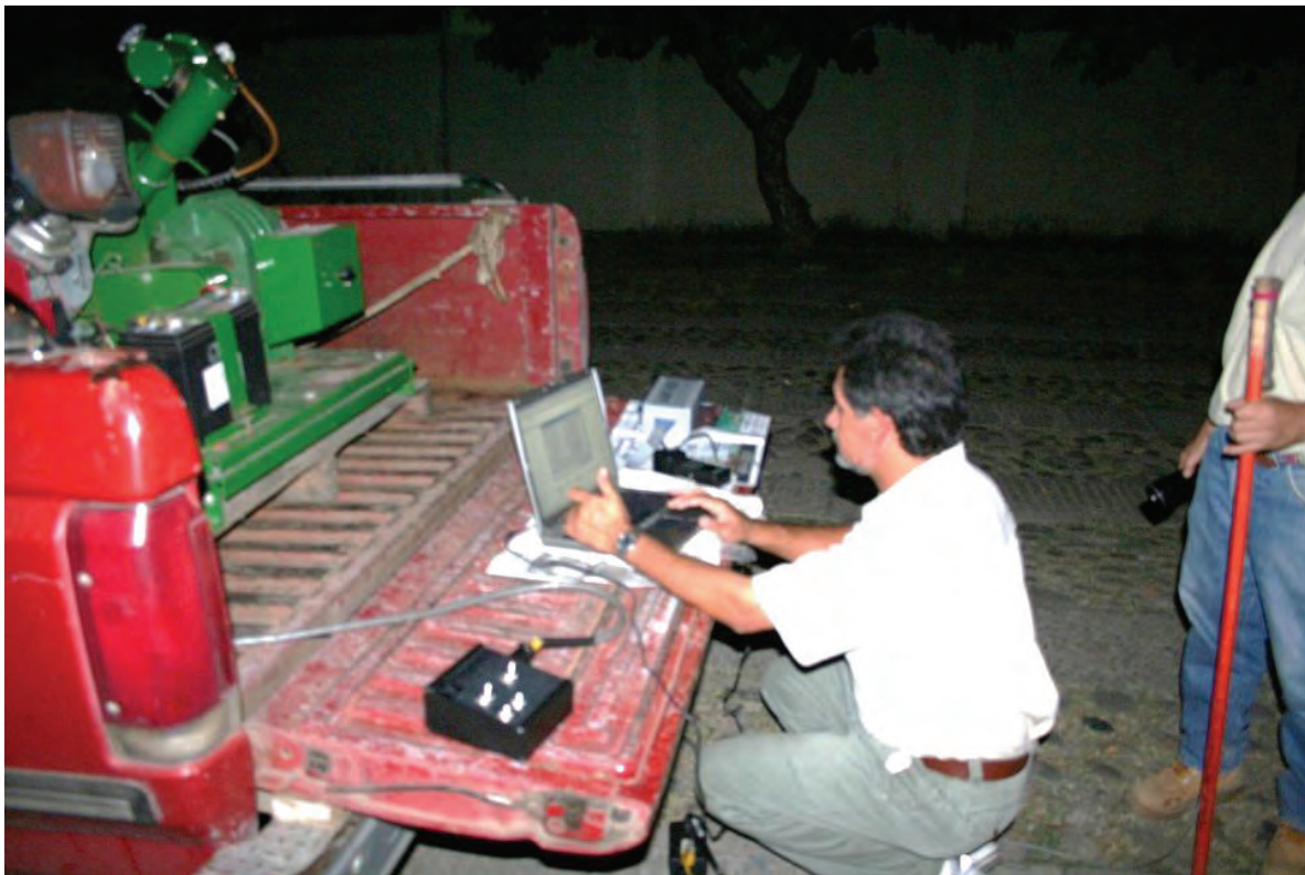
Figura 71. Calibrando en campo un equipo ULV con DCIV. Operativo de Dengue de la Secretaría de Salud (Fotografía de la autora).
