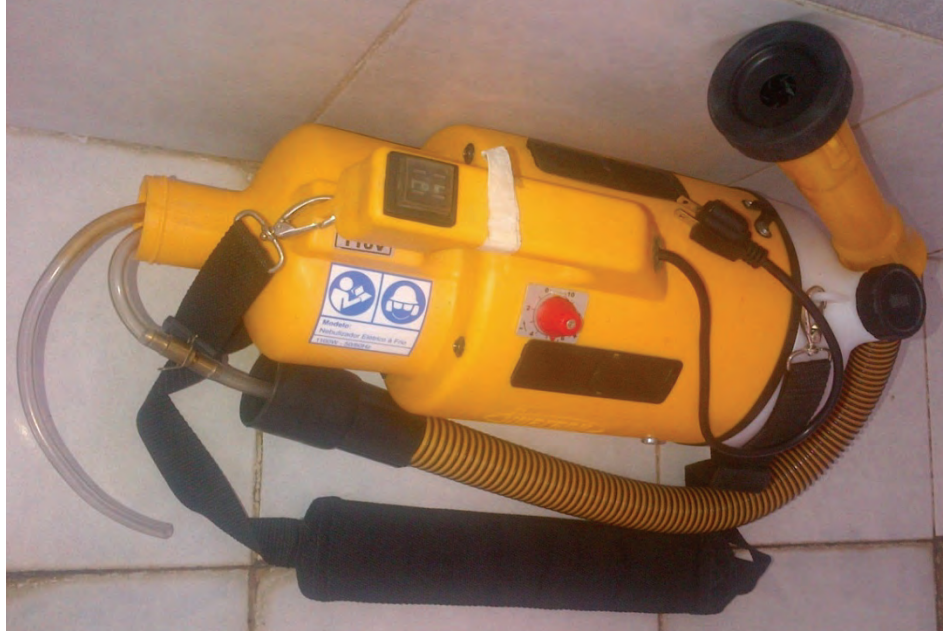
Figura 59. Equipo nebulizador motorizado para generación de aerosoles de Bajo Volumen (BV o LV) y Ultra Bajo Volumen (ULV). (Fotografía de la autora y equipo Guarany facilitado por Eco Suministros S.A. de C.V.)
