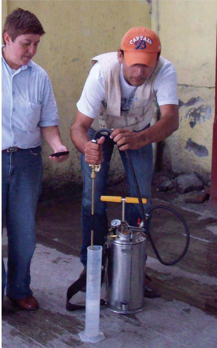
Figura 67. Calibración de bomba de presión manual para aspersión (Fotografía de la autora, ensayos con el personal de control de vectores de los Servicios de Salud de Morelos).
