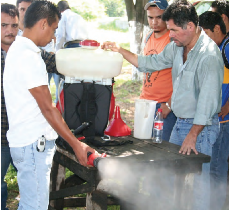
Figura 57. Motomochila para aspersión (Fotografía de la autora: personal del área de control de vectores de los Servicios de Salud de Nuevo León).|
