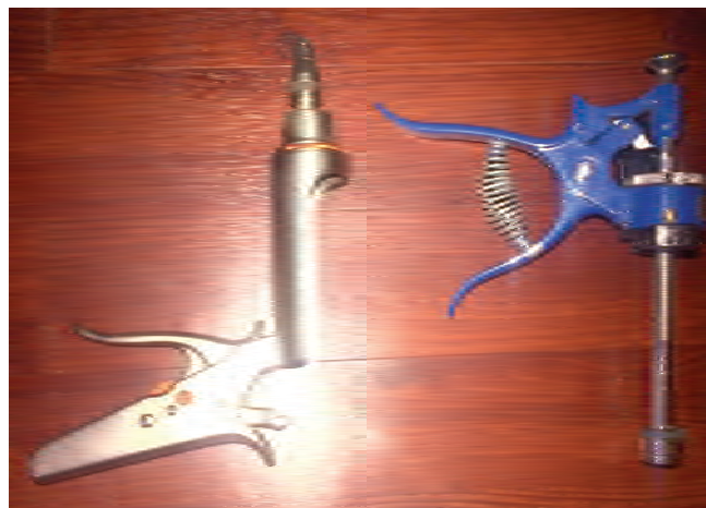
Figura 53. Pistolas para aplicación de cebos cucarachicidas u hormiguicidas (Fotografía de la autora).
