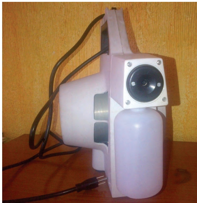
Figura 60. Equipo portátil para generación de Ultra Bajo Volumen M14 Micro-Gen (Fotografía de la autora).
