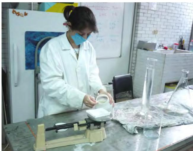
Figura 5. Preparando la solución de NaOH al 4%.
