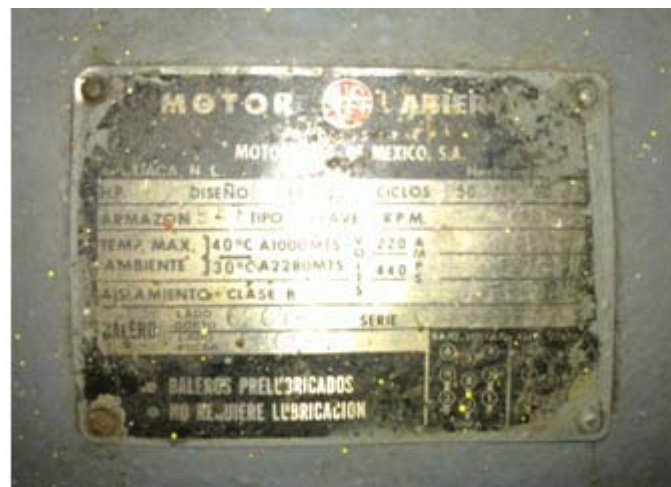
Fig. 1.13 Datos de la placa del motor agitador 1
