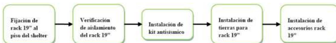
Fig. 2.1.-Montaje de Rack 19"
