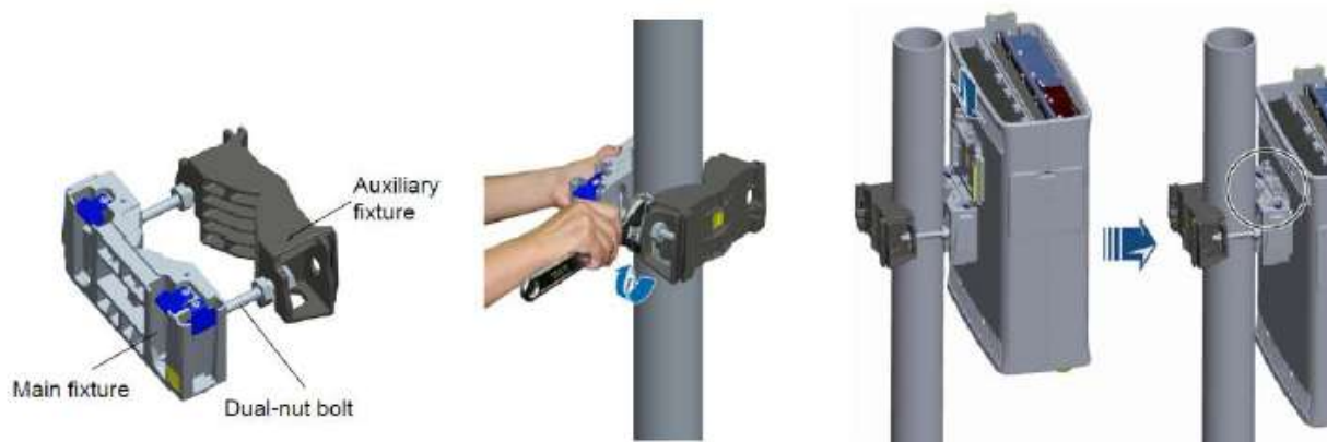
Figura 2.41.- Montaje de RRUs.
