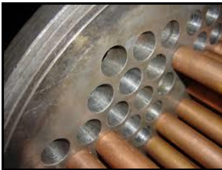
Figura 2. 11 Espejo de tubos con tubos incertados. 36
