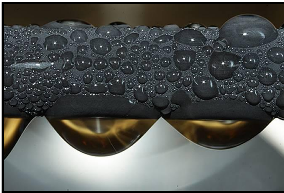
Figura 2. 5 Condensación por goteo. 29
