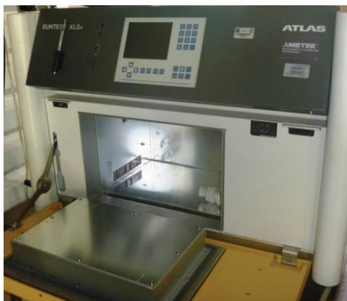
**Figura 2.4 Simulador solar Atlas SUNTEST XLS+**
