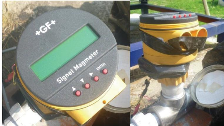
**Figura 2.8 Medidor magnético de caudal**
