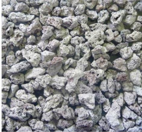
**Figura 2.3 Tezontle recubierto con 3 capas de  $\text{TiO}_2$**
