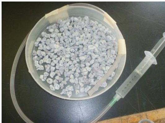
**Figura 2.11 Reactor Batch para el estudio de fotólisis de TCS**
