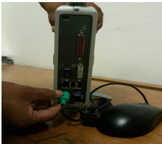
Figura 4.14 Instalación del ratón.
