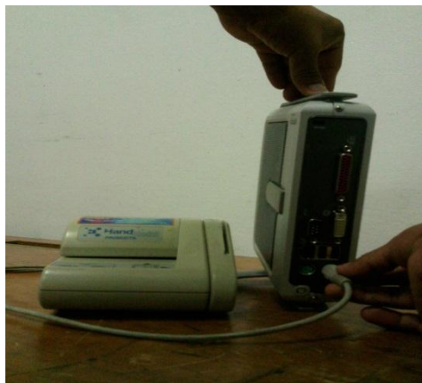
Figura 4.16 Instalación de lector de cheques y tarjetas.
