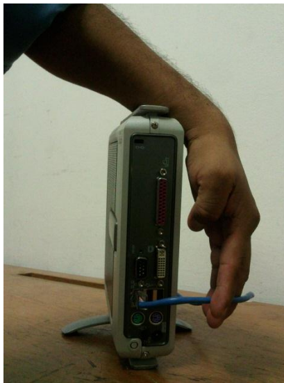
Figura 4.17 Instalación de cable de red.
