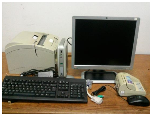
Figura 4.10 Componentes de un Thin Client
