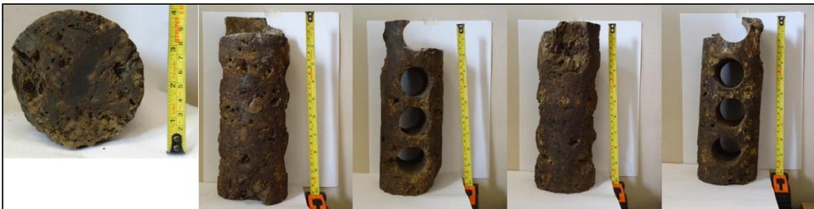
Fig.44 Imágenes de una de las muestras de núcleo del pozo “X” del yacimiento “M”.
