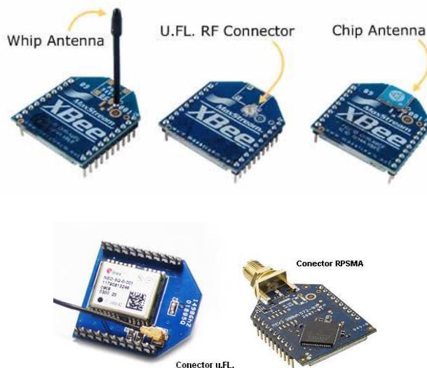
Fig. 2.6 Tipos de antena
