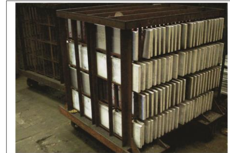
Distribución de longotes para tratamiento térmico Fig.4.2E Cortesía MAHLE Componentes de Motor de México
