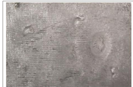
Defecto: Rechupe en la base del lingote Fig.1.3.B Cortesía MAHLE Componentes de Motor de México
