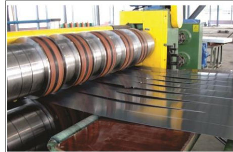
Cortadora de bobina de acero por medio de cizallamiento Fig.4.2.I
