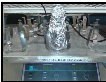
**Ilustración 4.6. Sistema del proceso Fenton en fase homogénea.**
