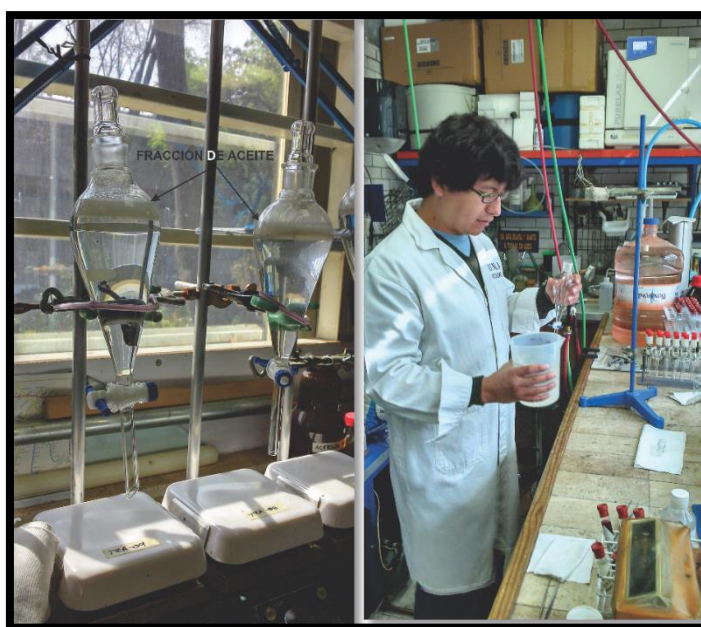
Figura 3.10. Fotografías del proceso de separación de fracciones de aceite en agua de lluvia colectada. Izquierda, embudos de separación con muestras después de 24 hrs. Derecha, obtención de agua libre de aceite.
