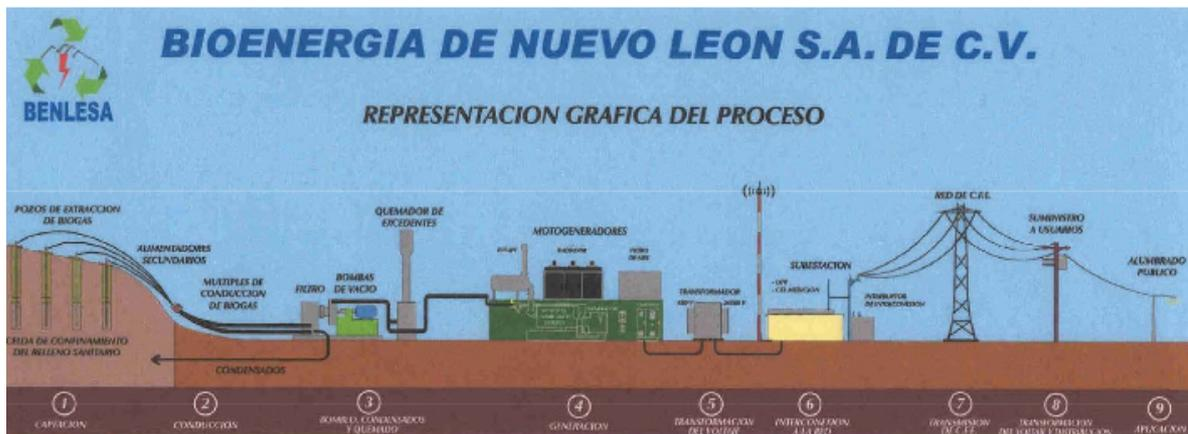
**Figura 1.4** Diagrama del proceso de generación de energía eléctrica de la planta de BENLESA.
