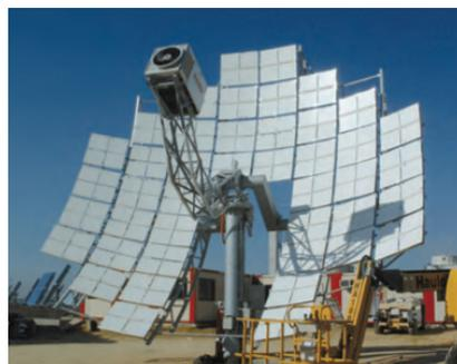
**Figura 1.10** Disco parabólico con motor Stirling
