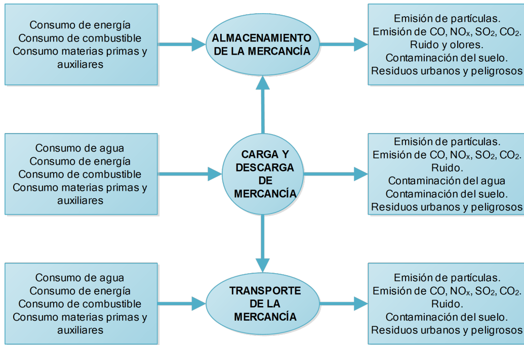
Figura 2.4: Diagrama de proceso de la actividad portuaria carga y descarga de granel sólido.
